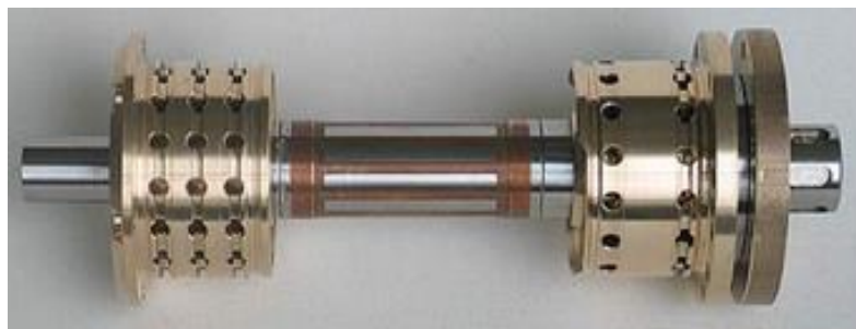
Luftlagerung einer Hochfrequenz-Spindel für das Leiterplattenbohren
